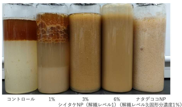
図8 しいたけ NP の固形分濃度が及ぼす分散・乳化の影響
