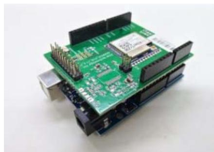
実習で使用するArduinoシールド基板
