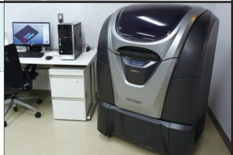
◆**複合・大型3Dプリンター**（米子施設：計測制御科）
