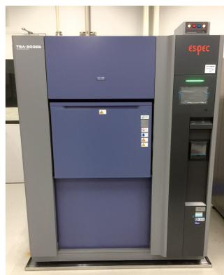
大型冷熱衝撃試験器
