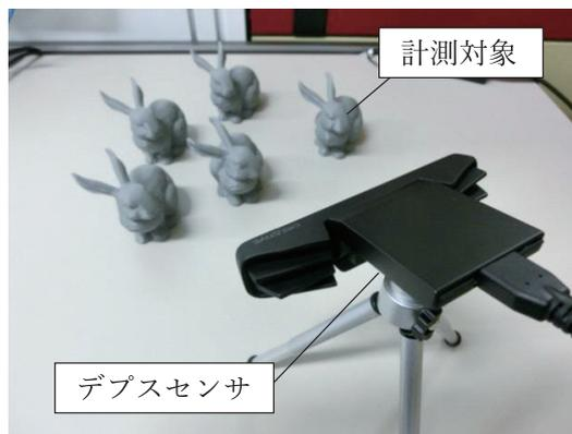
図1 デプスセンサによる三次元空間計測
