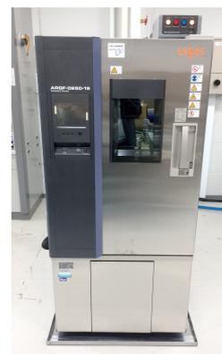
急速温度変化試験器
