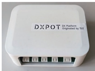
DXPOT:様々なセンサが接続でき、 工程内の各種センシングが可能
