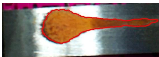
図4 HSV画像から求めたさびの輪郭
