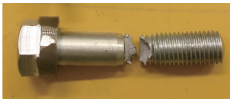
材料試験機で強制破断させたボルト
