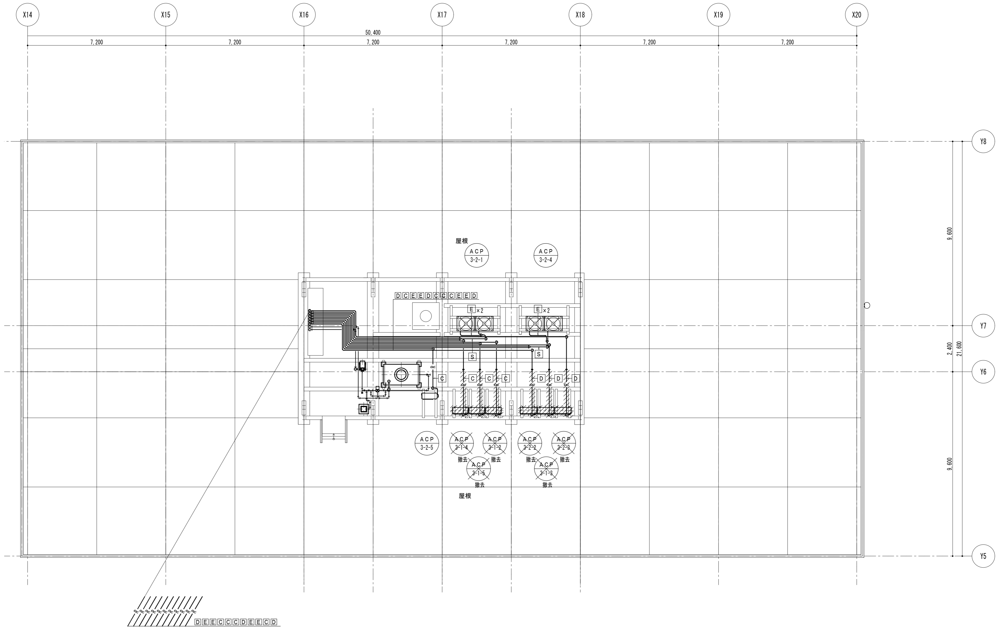
空調設備 撤去 実験棟(1)屋上平面図 S=1/100
