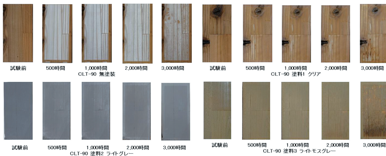
図4 促進耐候性試験における試験面性状の変化 (CLT-90)
