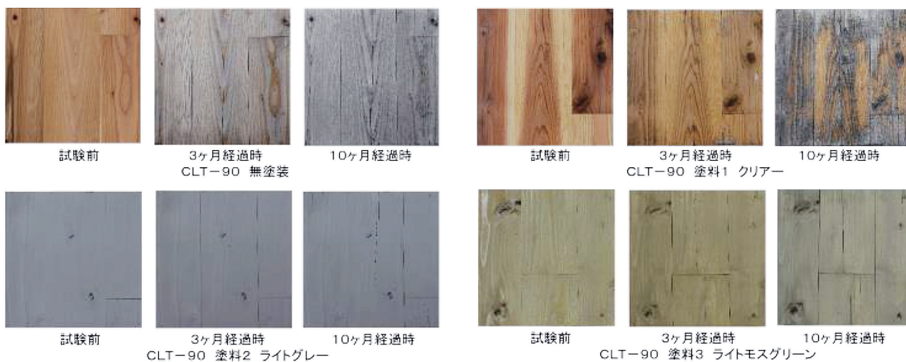
図10 屋外暴露試験による試験面性状の変化 (CLT-90)
