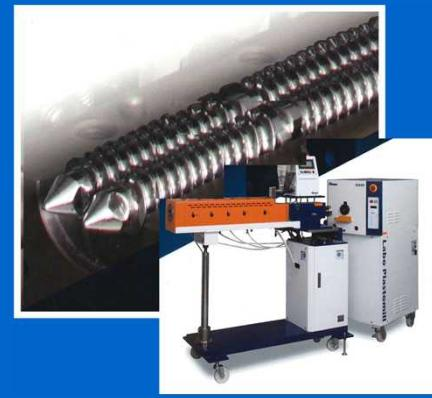
サーキュラーエコノミー（循環型経済）実現を目指す中で、プラスチックリサイクルの重要性が高まっています。また、自動車・医療・電子部品など幅広い分野で、金属に代わる材料として強度や耐久性の向上、新機能の付与を目指した機能性プラスチックの開発が盛んになっています。そこで当センターでは、それらに向けた動きを加速させるため、このたび二軸混練システムを新しく導入しました。
