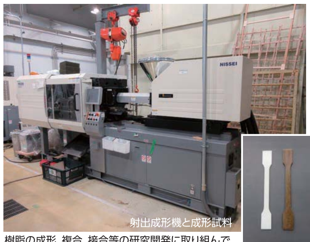
射出成形機と成形試料 樹脂の成形、複合、接合等の研究開発に取り組んでいます。
