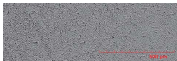
温度条件の異なる鍛造加工後の鉄鋼ミクロ組織 (上:冷間加工、下:温間加工)
