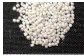
FE-SEMで観察した吸着材料原料 (ハイドロタルサイト粉末) 造粒製品 (粒径約1mm)
