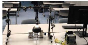
AI異常検知用撮影デモ装置 (カメラ、照明)
