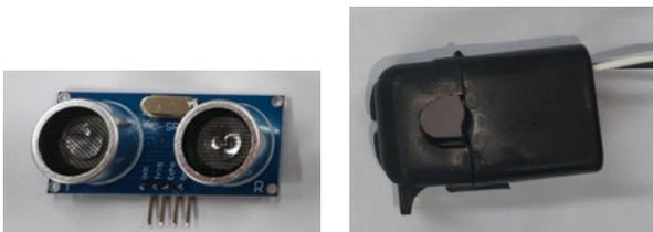
(a) 超音波式距離センサ (b) クランプ式CTセンサ
