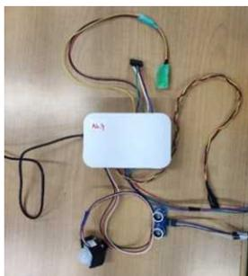
図5 センサを取り付けたエッジコンピュータ
