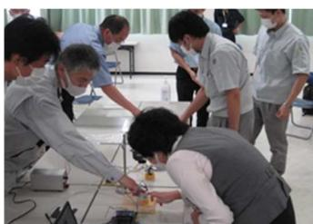
放熱塗料によるモータの温度変化測定実験
