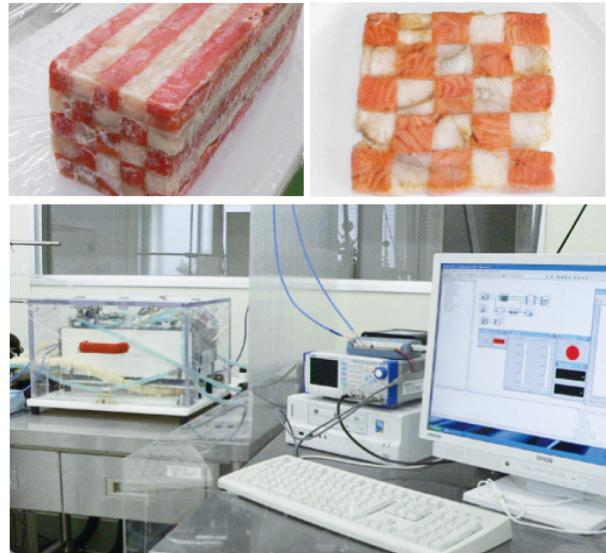
大型成型化した魚肉と通電加熱装置
