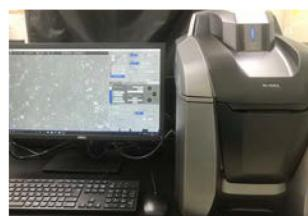
培養中の培養細胞、細菌、組織片、三次元培養塊等の、広範囲な視野や厚みのある試料の観察ができます。
