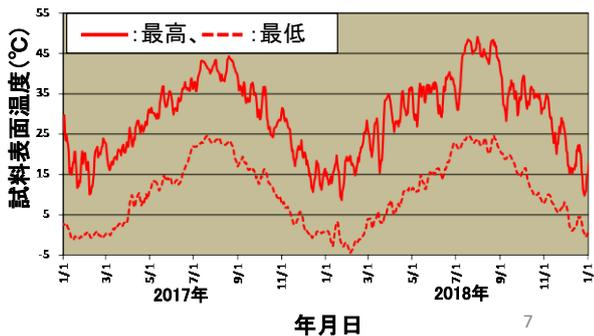
図6 暴露試験期間中の試料表面の温度変化
