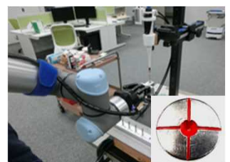
協働ロボットによる自動塗装
