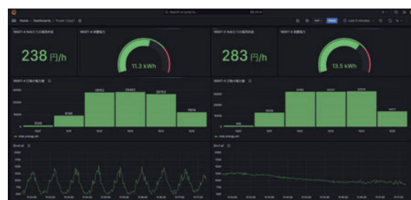
新旧水冷ポンプによる電力消費量 (左) 新ポンプ (右) 旧ポンプ
