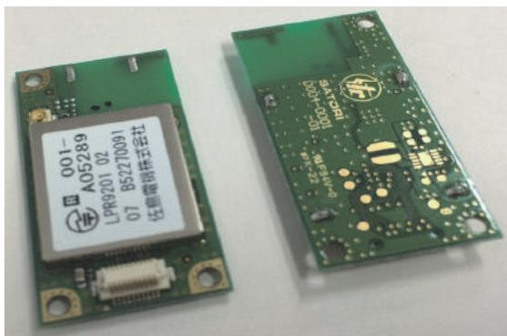
図 1 920 MHz 帯特定小電力無線モジュール
