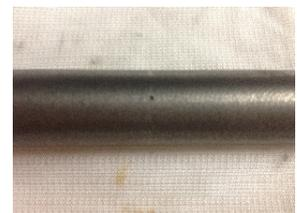
図2 鑄巣欠陥の例
