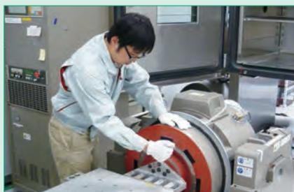
温湿度サイクル試験をかけながら、振動(加振)試験を行うことができます。
