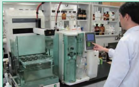
公定法であるケルダール法を用い食品中の窒素やタンパク質を分析します。試料の分解、蒸留、滴定を自動で行うことができます。
