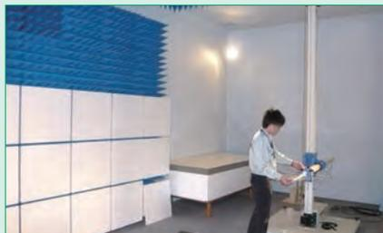
外部からの電磁波の影響を受けずに、電子機器からの放射される電磁波ノイズの測定を行うことができます。
