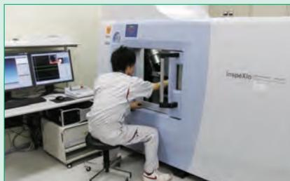
X線を電子部品等に照射し、非接触、非破壊で電子部品・製品等の内部構造の3次元画像を得ることができます。
