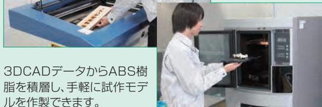
3DCADデータからABS樹脂を積層し、手軽に試作モデルを作製できます。
