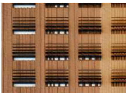
図3 硬質部分の残存(杉・彫刻加工)
