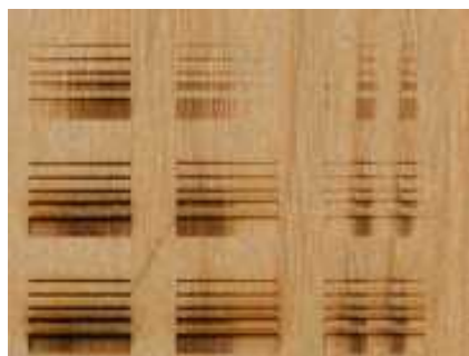
図4 導管部分だけが焦げる(ホワイトアッシュ、レッドオーク・彫刻加工)
