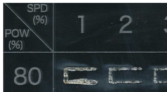
図7 加工部の融解・変形(ガラス・カット加工)
