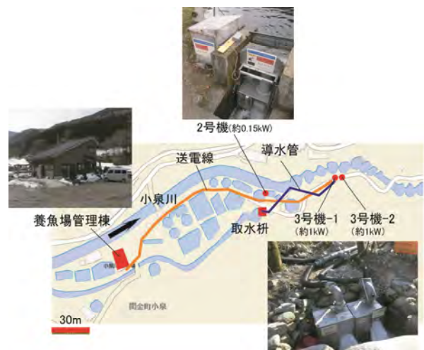
図1 実証試験における発電装置などの設置状況
