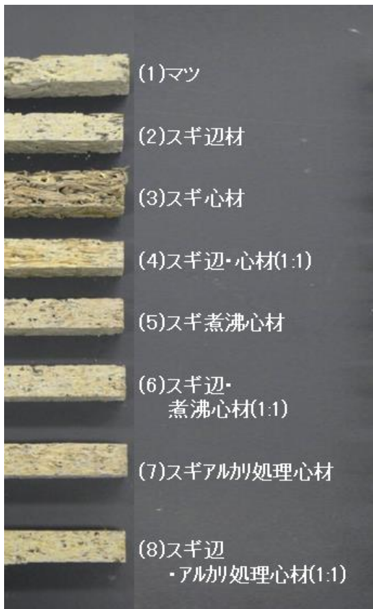
図2 曲げ試験片断面
