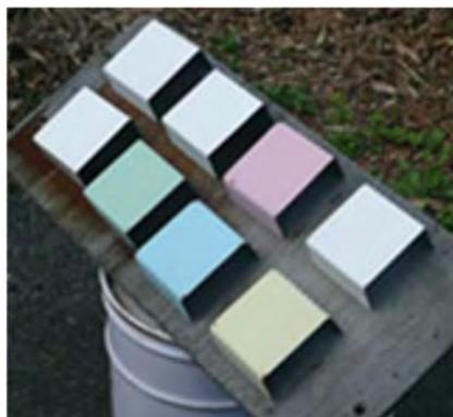
支援事例②の製品化事例（中空無機粒子を配合した遮熱・保温塗料）
