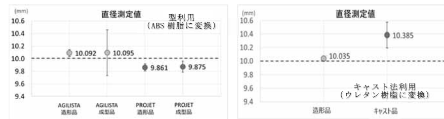
材料変換時のφ10mmの円柱直径値の測定結果とバラつき
